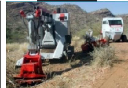
Das unbemannte Multifunktionswerkzeug MAXX. Im Hintergrund das kleine gepanzerte Kommandofahrzeug.
